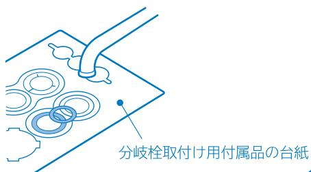
分岐栓締め付けキャップをパイプに通す。
