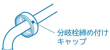
固定用リングをパイプの先端にはめ込む。
