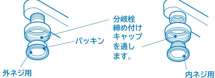
分岐栓を下から水平に当て、分岐栓締め付けキャップを締め付ける。
