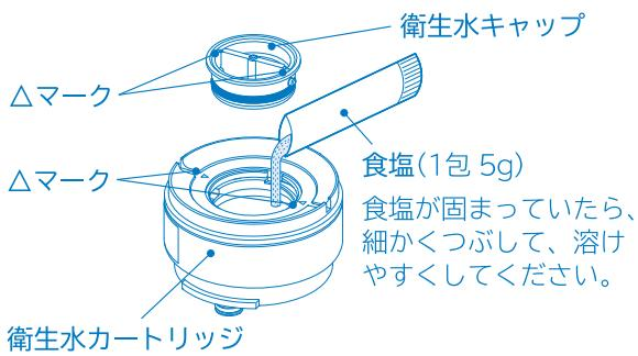
食塩の量は生成する衛生水の水量に合わせて入れてください。
