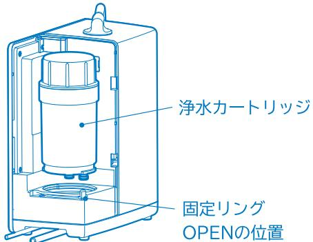
※硬く引き抜きにくい場合は、本体を上から押さえて、浄水カートリッジを前後にゆらして引き抜く。
